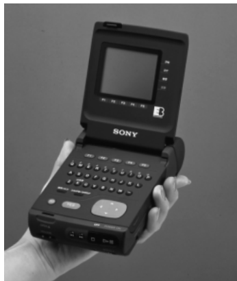
1990年にソニーが発売した「データディスクマンDD-1」。8センチCD-ROM専用プレーヤー1号機である。
